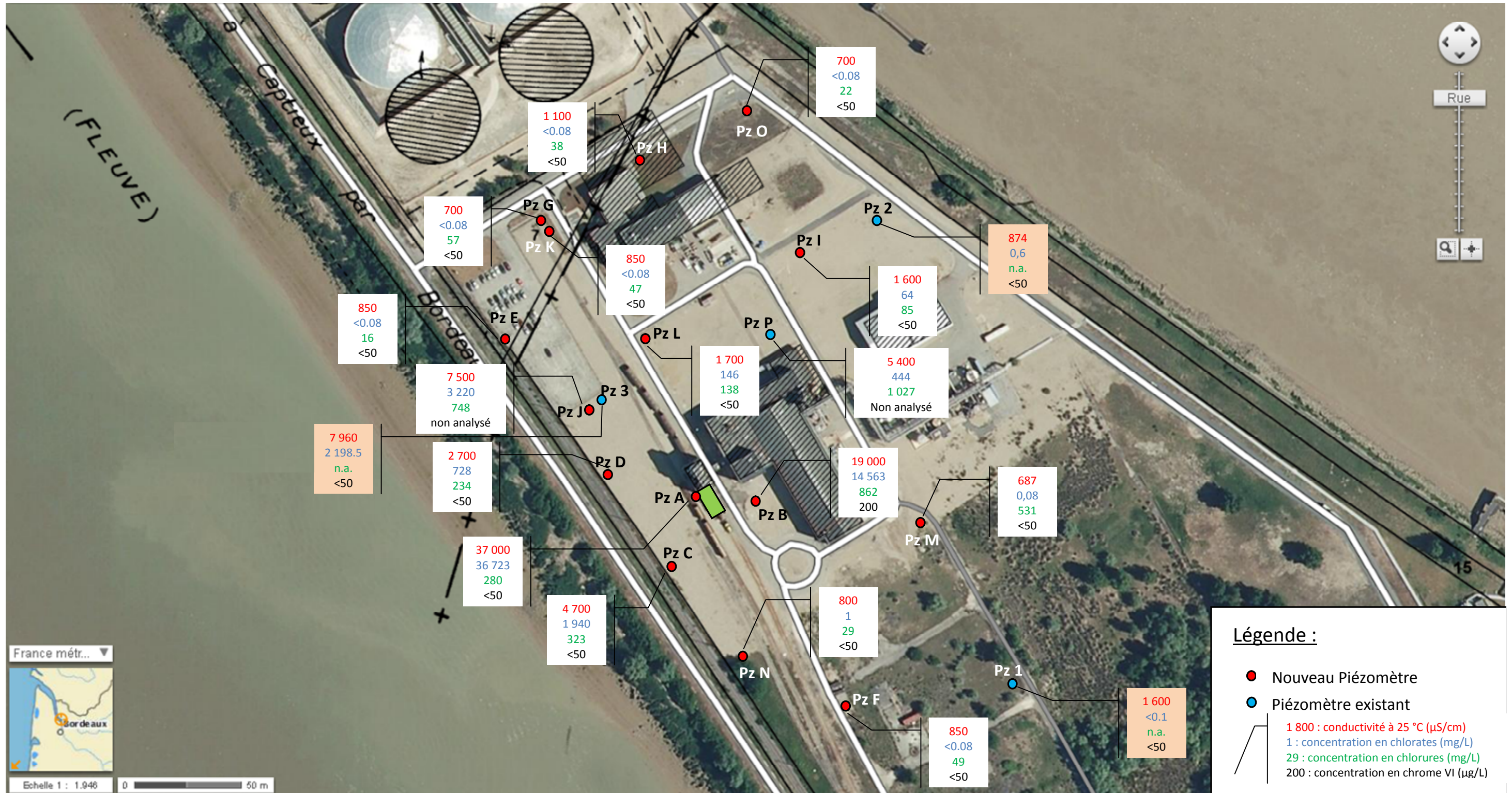
Figure 7 : Synthèse cartographique de la conductivité et des résultats d'analyses portant sur les chlorates, les chlorures et le chrome VI (Source : www.geoportail.gouv.fr )
